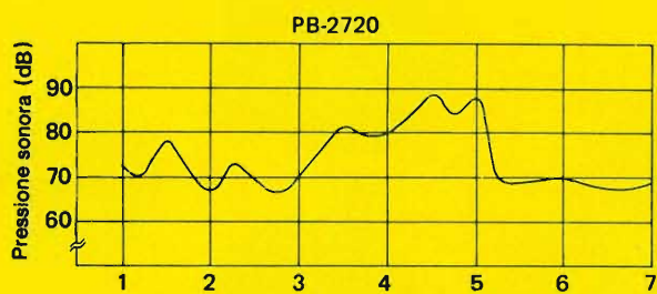
Fig. 4 - Grafico relativo al modello PB 2720 del livello del suono in funzione della frequenza.
